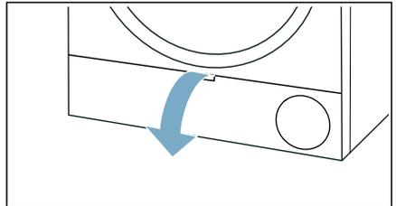
3. Hebel der Wärmetauscher-Abdeckung entriegeln.
