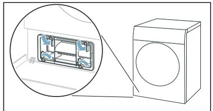
4. Wärmetauscher-Abdeckung am Griff herausziehen.
