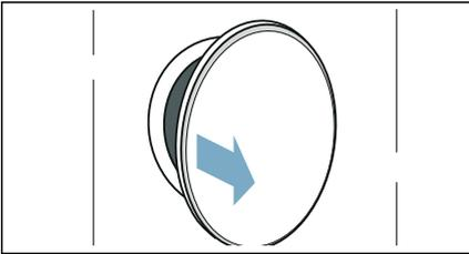
2. Feuchtigkeitssensor mit angerauhtem Schwamm reinigen.
